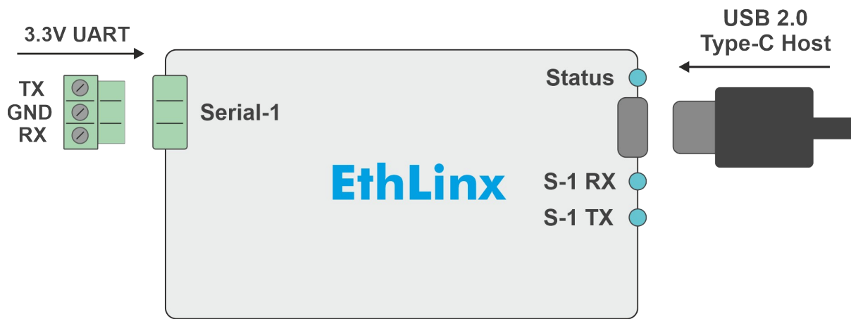
Obrázek 1: Základní schéma zapojení se sériovými přípojkami a popisem LED, EthLinx
