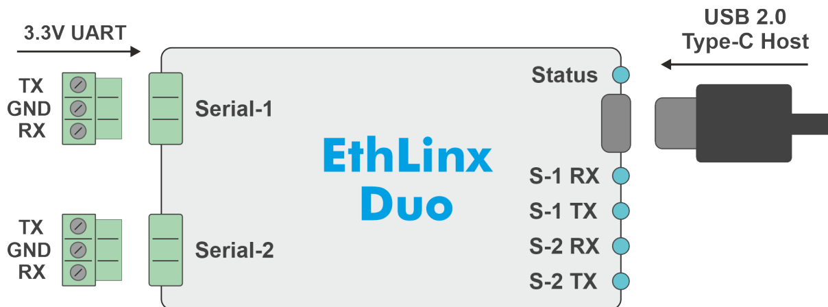
Obrázek 2: Základní schéma zapojení se sériovými přípojkami a popisem LED, EthLinx Duo
