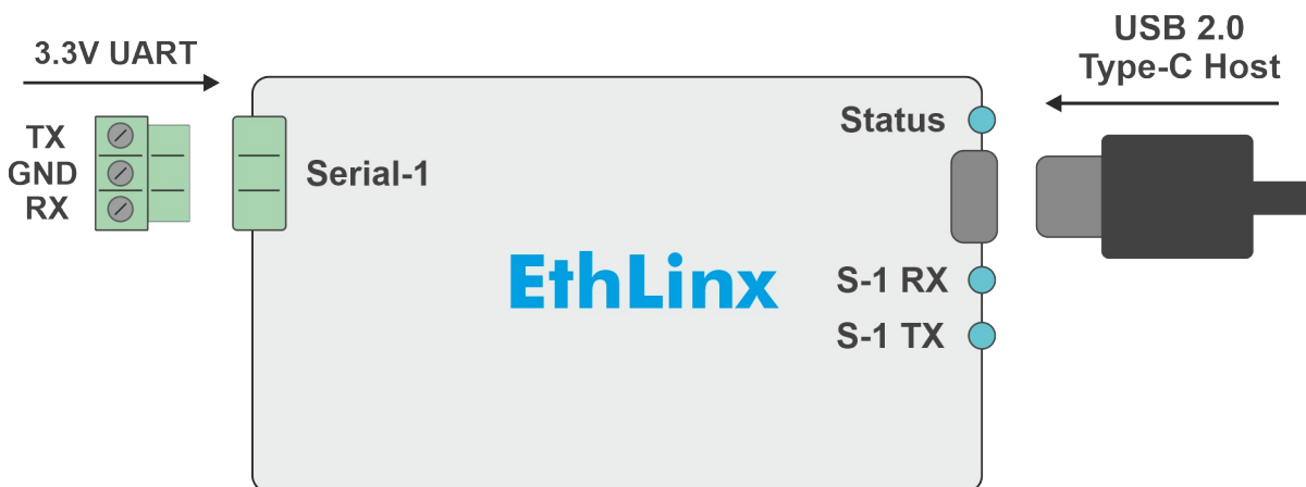
Abbildung 1: Grundlegender Schaltplan mit seriellen Anschlüssen und LED-Beschreibung, EthLinx
