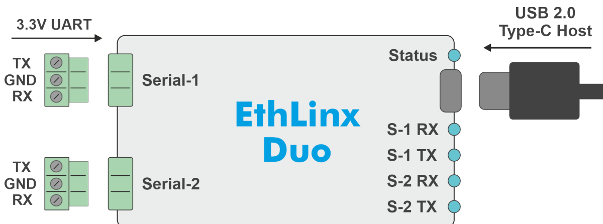
Abbildung 2: Grundlegender Schaltplan mit seriellen Anschlüssen und LED-Beschreibung, EthLinx Duo
