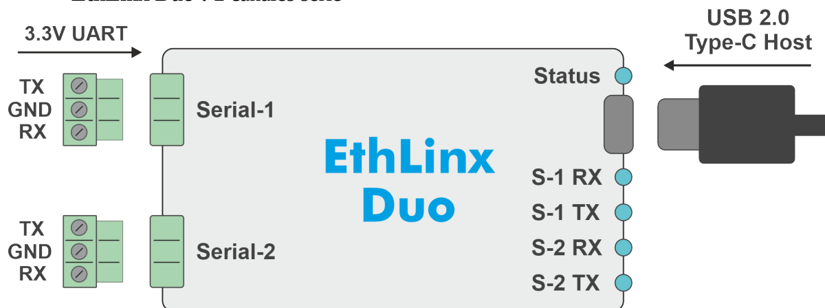
Imagen 2: Diagrama de cableado básico con conexiones serie y descripción de los LED, EthLinx Duo
