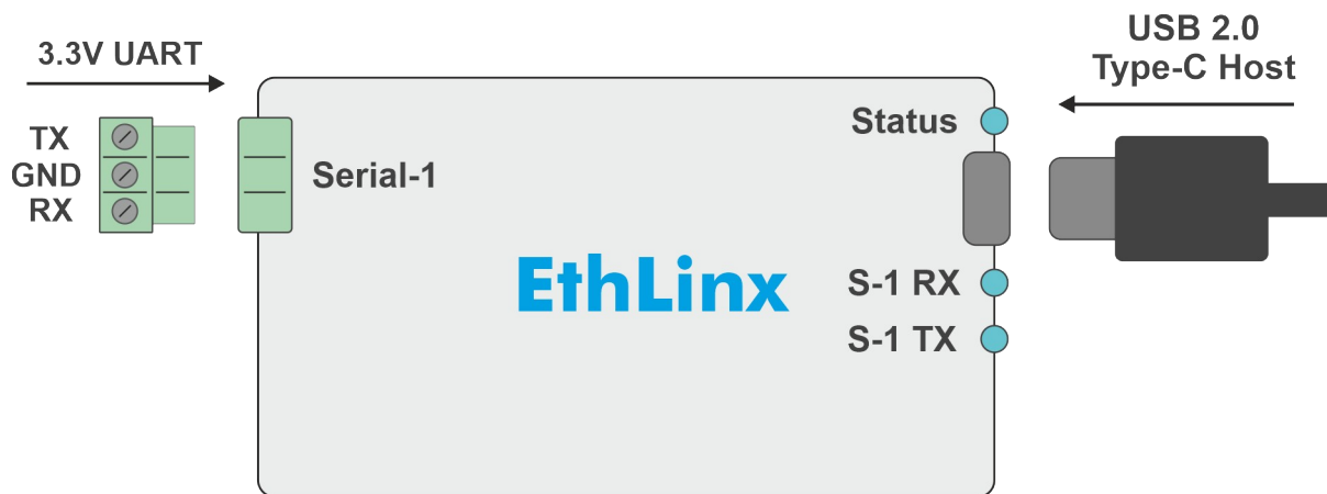
Image 1 : Schéma de câblage de base avec connexions série et description des LED, EthLinx
