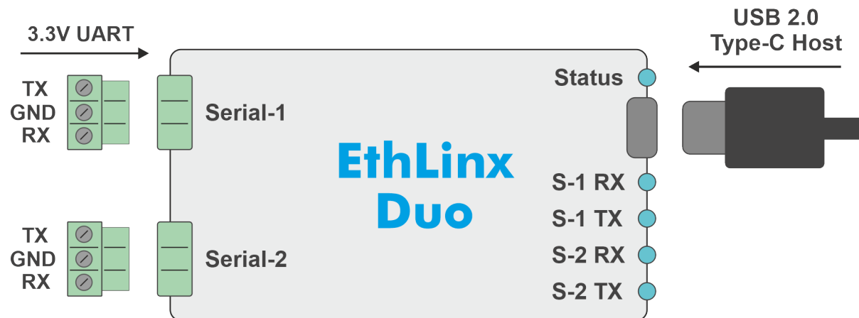
Image 2 : Schéma de câblage de base avec connexions série et description des LED, EthLinx Duo
