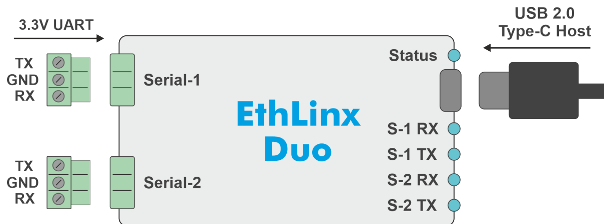
Immagine 2: Schema di cablaggio di base con connessioni seriali e descrizione dei LED, EthLinx Duo
